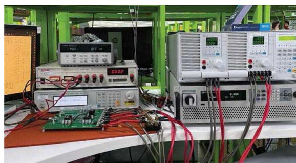
**Рисунок 7.** Установка для проверки втекающего/вытекающего тока.
