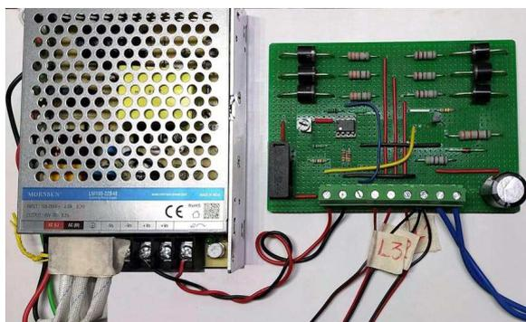
**Рисунок 10.** В этой схеме AC/DC преобразователь и печатная плата смонтированы на общей панели.
