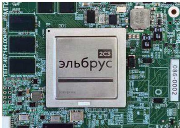
Главной особенностью нового одноплатного компьютера MPC21, разработанного специалистами ИНЭУМ им. Брука Концерна «Автоматика» (входит в «Росэлектронику»), является то, что устройство работает на базе
