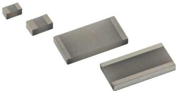
**Рисунок 3.** Тепловая перемычка очень проста и не дает никаких намеков на ее назначение.
