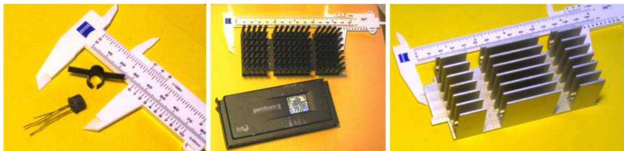
**Рисунок 2.** Три радиатора, которые я собрал за эти годы: радиатор с «крыльями», надеваемый на транзистор в металлическом корпусе ТО-5 (левый); радиатор, разработанный для Intel Pentium II конца 1990-х годов (средний); большой радиатор для модуля силового преобразователя (правый).
