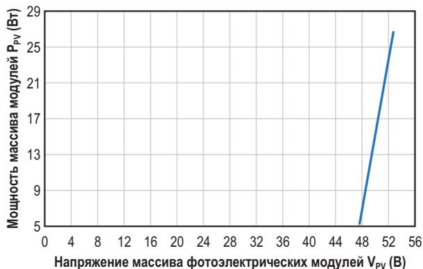
**Рисунок 4.** Зависимость мощности массива панелей от напряжения массива  $V_{PV}$  для SDL с выключенным преобразователем.
