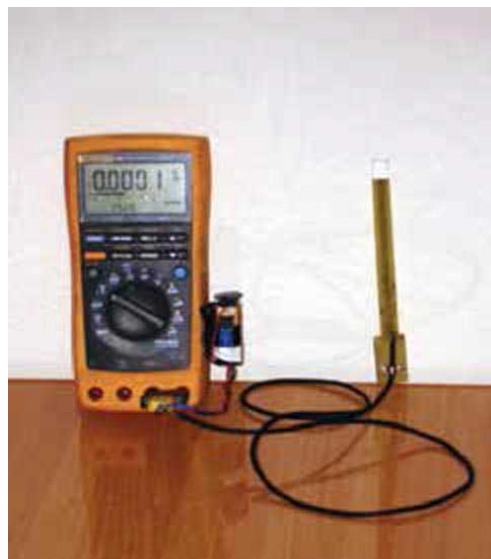
Рисунок 2. В режиме относительных изменений цифровой мультиметра (REL) отображаемые показания близки к нулю, а номинальное выходное напряжение датчика при нулевом поле составляет 2.25 В.
