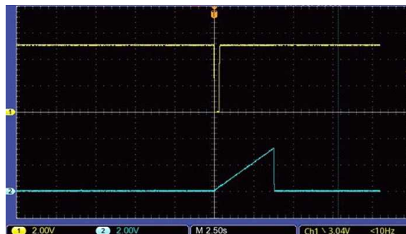
Рисунок 5. Импульс запуска и линейно нарастающее напряжение на конденсаторе C_X .
