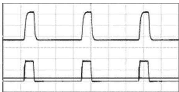
Рисунок 2. При входном постоянном напряжении 3 В (горизонтальная линия внизу) напряжение на выводе SW микросхемы стабилизатора IC 1 достигает пиковых значения порядка 18 В (импульсный сигнал внизу). Соотношение числа витков 1:6 дросселя L 1 дополнительно увеличивает пиковое выходное напряжение до 160 В (верхняя осциллограмма), чтобы после выпрямления получить на выходе постоянное напряжение 100 В. Из-за автотрансформаторного включения дросселя нижний уровень импульсов на верхней осциллограмме составляет -6 \times V_{IN} (-18 В).
