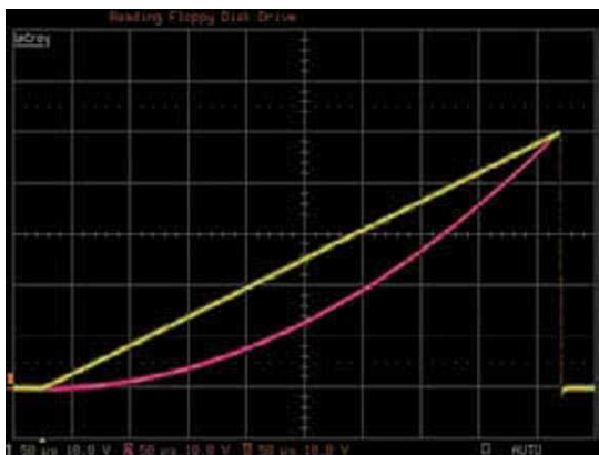
Рисунок 2. В середине импульса уровень напряжения квадратичного параболического импульса (розовая кривая) составляет ровно одну четвертую от его пикового уровня.
