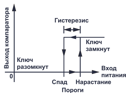
Рисунок 3. Добавление гистерезиса к порогу блокировки при пониженном напряжении с помощью резистора, соединяющего среднюю точку делителя с выходом коммутатора
