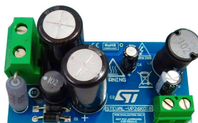
STEVAL-VP26K01B – типовая конструкция понижающего преобразователя 15 В/100 мА на основе VIPER26K.
