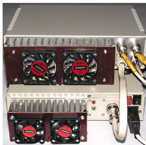
Рисунок 12. Фотография конструкций устройств обдува радиаторов усилителя [1] (сверху) и ИП [2] (снизу).
