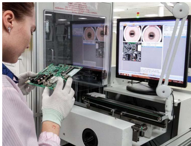
Рисунок 5. Автоматизированная система контроля.
