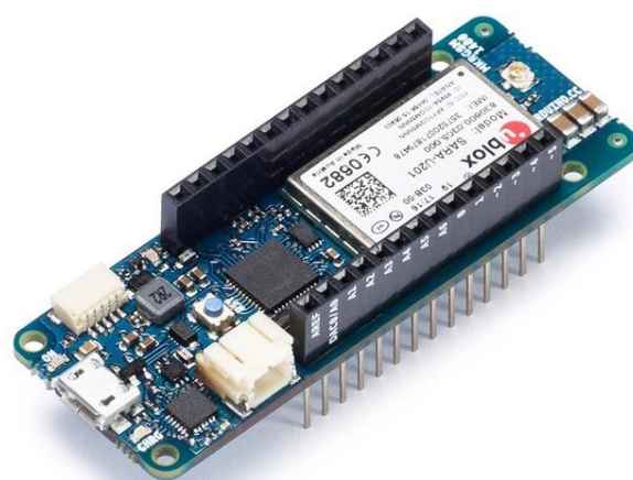
Рисунок 2. Плата Arduino MKR GSM 1400 содержит микроконтроллер Atmel SAM D21 и GSM модуль SARA-U201.
