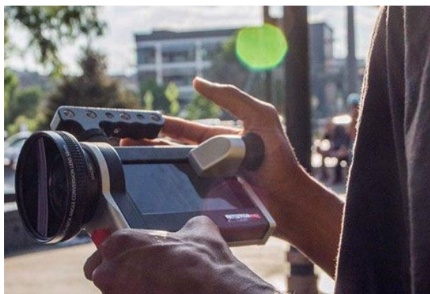
Рисунок 3. Похожая на Super 8 камера Lumenati CS1 вместо пленки использует iPhone 6. Вы вставляете свой iPhone в заднюю часть этого аппарата так же, как когда-то вставляли кассету с пленкой в оригинальную, но теперь уже вышедшую из употребления пленочную камеру Super 8.
