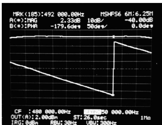
Рисунок 3. Логарифмическая частотная характеристика представляет полосу пропускания фильтра на основе микросхемы MSHFS6.
