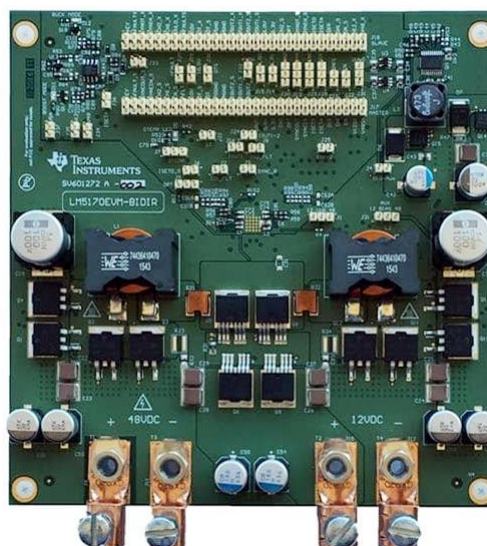
LM5170EVM-BIDIR: Оценочный модуль двунаправленного преобразователя 48 В /12 В на основе микросхемы LM5170.
