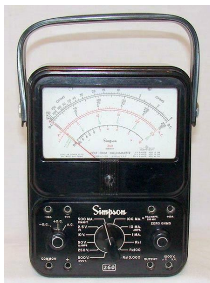
Рисунок 4. Вольтметр Simpson 260, который все еще можно купить у компании Simpson Electric, славился надежностью и точностью (для своего времени, конечно же).
