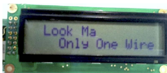
Рисунок 1. Типичный модуль ЖК индикатора.
