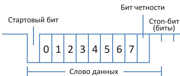
Рисунок 1. Поток последовательных данных UART.
