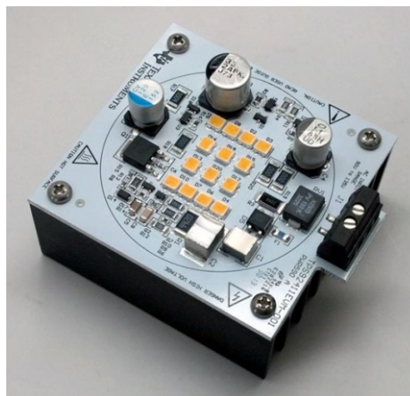
Демонстрационная плата TPS92411EVM-001 для прямого линейного управления светодиодами от сети 120 ВАС
