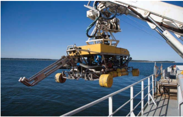
Созданный Nexans аппарат «Саржект» может рыть траншеи в мягких или твердых отложениях, работая на глубинах до 1000 метров.
