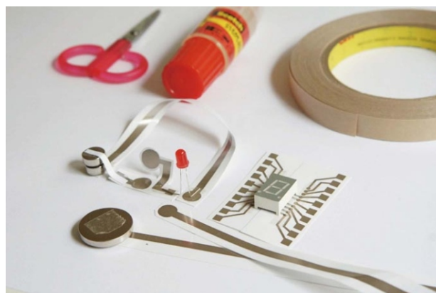
Соединение компонентов с помощью двухсторонней проводящей клеящей ленты.
