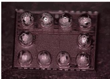
Рисунок 5. 10-контактный корпус WCSP компании Maxim Integrated площадью примерно 3 мм 2 .
