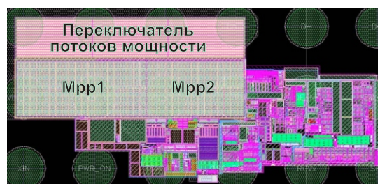
Рисунок 7. Топология реализованной схемы зарядного устройства.
